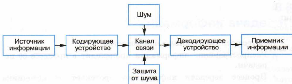
Рис. 2.1. Модель передачи информации по техническим каналам связи
